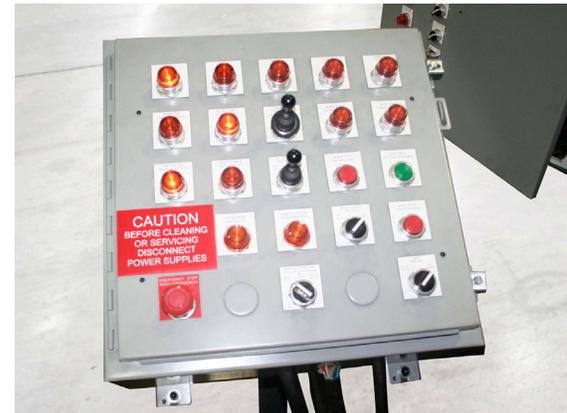
Controlar múltiples reservorios de resina con un operador puede resultar en quedarse sin resina en el momento equivocado; reemplazarlo por paneles de control con sistemas de bombeo de última generación que incluyan sistemas de monitorización de cada mezcladora suele solucionarlo.
