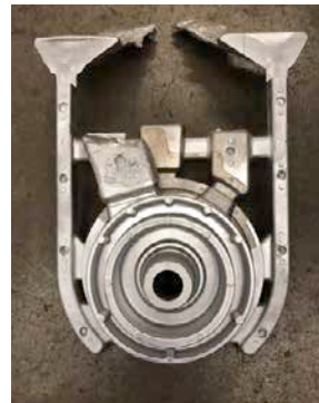
Pieza Colada Mediante Colada Basculante Tradicional Usando Canales en la Línea de Partición
