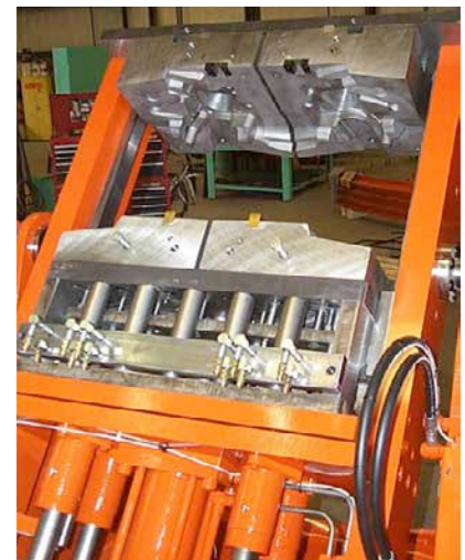
Molde para Colada Basculante Reversa en la Máquina
