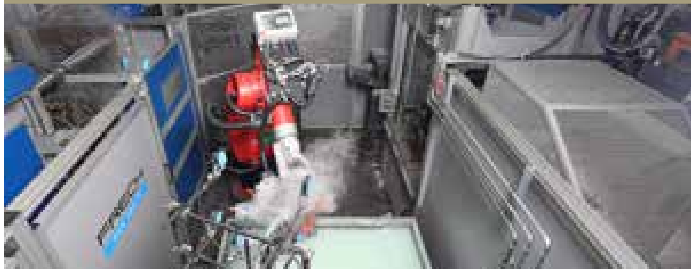
Ahora el robot sostiene la pieza completa en un baño quench para bajar la temperatura a un rango óptimo para los procesos subsiguientes.
